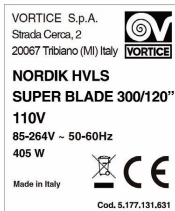
Fig. 1 - Ejemplo placa de datos para SUPERBLADE 300/120" 110V
